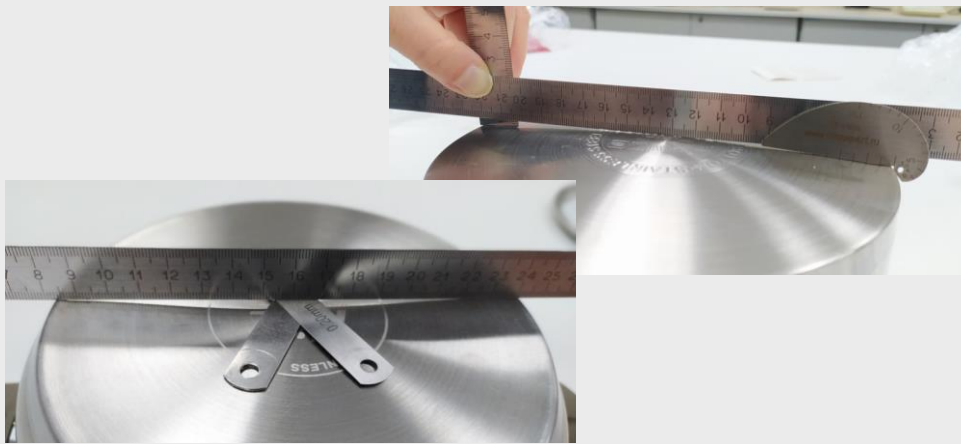
Измерение отклонений от плоскостности дна
