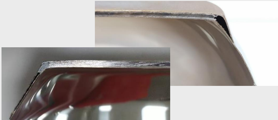
Срезы дна изделий. Распределение теплораспределительного слоя.
